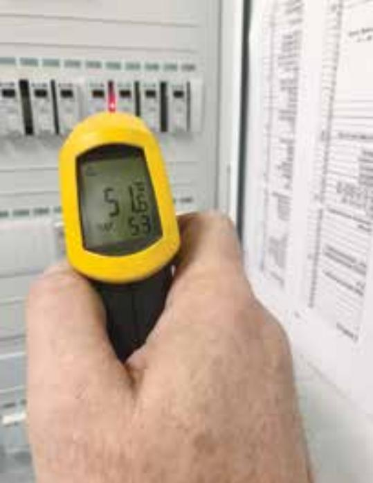
Das Thermometer belegt es: Über 50 °C Hitze an einem Schaltrelais. Die Ursache ist oft ein billiges Produkt, was möglicherweise zu verheerendem Brand führen kann.
