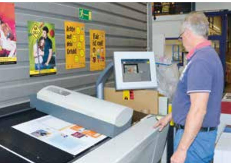
**2.** Druckabnahme: Offset-Drucker Ulli Weitershagen kontrolliert mit Hilfe eines Densitometers (Farbdichtemesstisch) an einem ersten bedruckten Bogen, ob die Farben korrekt auf dem Papier dargestellt werden. Dieser Prozess wird alle paar hundert Bögen wiederholt. Auf diese Weise wird gewährleistet, dass eventuelle Farbabweichungen direkt nachjustiert werden können.
