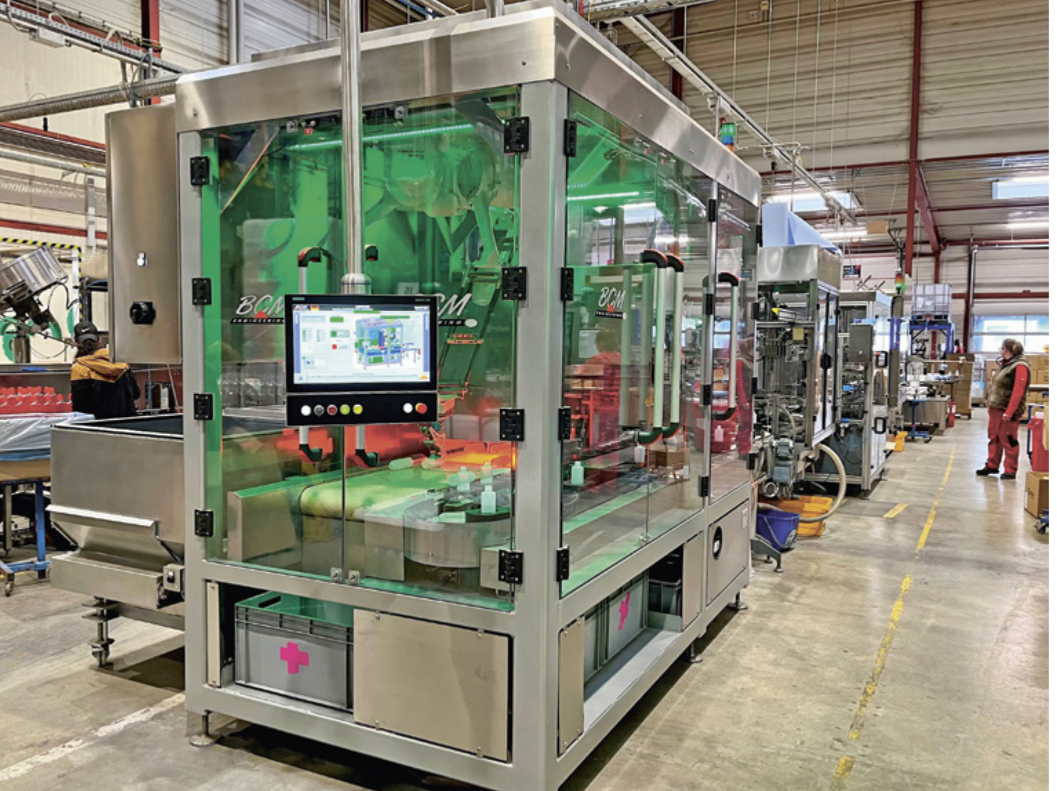
Der zweite robotergesteuerte Flaschenaufsteller am Chemiestandort Pfaffen-Schwabenheim steigert die Effizienz in der Produktion und unterstützt das Team angesichts des Fachkräftemangels.
