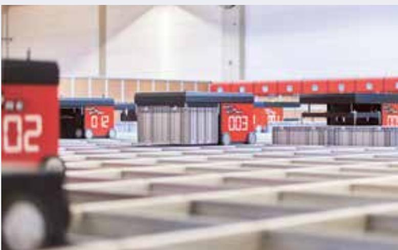
*Die Roboter der AutoStore Anlage in Betrieb.*
